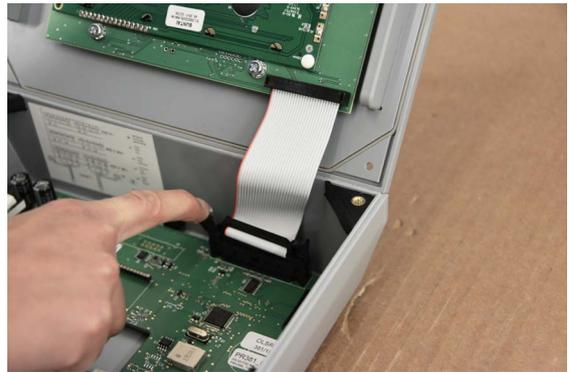
Flachbandkabel Riegel links und rechts öffnen und Frontplatte entfernen.
