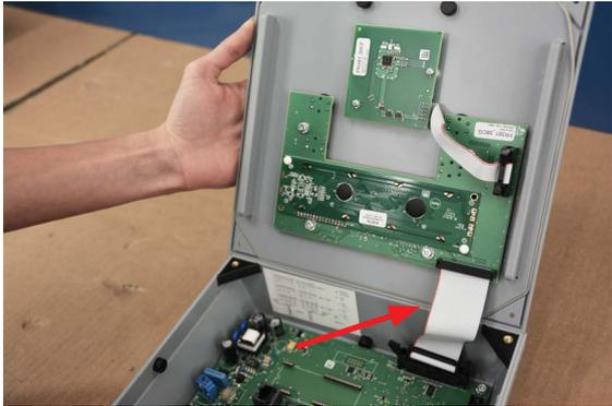
Frontplatte nach oben öffnen. Achtung Flachbandkabel.
