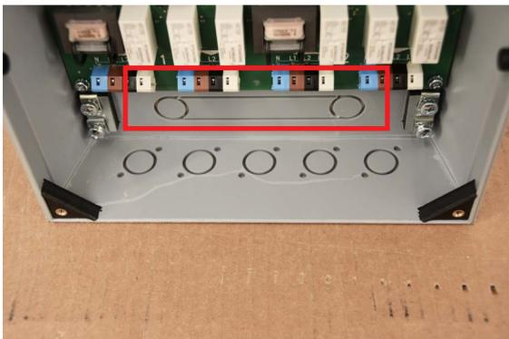
Entsprechend der Installation die Kabeldurchführungen herauschneiden. Das „Langloch“ ist nicht geeignet für eine staubgeschützte Montage.
