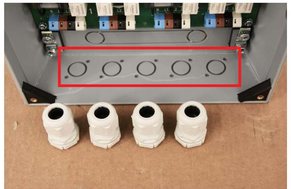
Staubgeschützte Montage: Entsprechende Löcher in der Seitenwand herausbrechen und die Kunststoffkabelverschraubungen verwenden. Die Kabelverschraubungen sind für Kabeldurchmesser von 6-13 mm ausgelegt.
